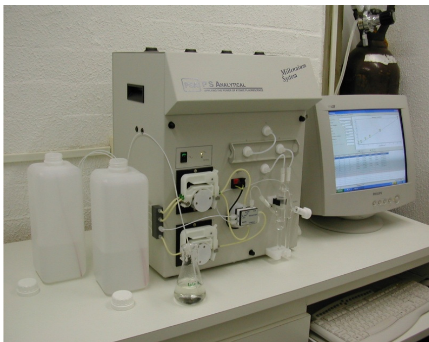
Figura 4: Espectrofotômetro de fluorescência atômica, PSA Millennium Merlin 10.025, utilizado na detecção de Hg.
