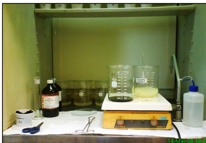
Figura 12: Procedimento de lixiviação da fibra-Mn para remoção dos isótopos ^{226}\text{Ra} e ^{228}\text{Ra} .
