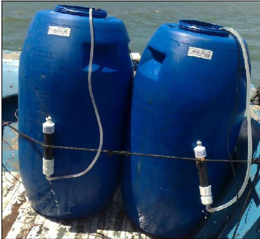
Figura 10: Tambores de amostragem de 200 L para os pontos distantes da costa com as colunas conectadas para remoção quantitativa do Ra na própria embarcação.
