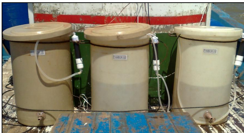
Figura 9: Tambores de amostragem de 90 L para os pontos próximos à costa com as colunas conectadas para remoção quantitativa do Ra na própria embarcação.
